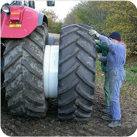
5. Не допускается эксплуатация техники с дополнительными колесами на проставках, когда установленное давление во внешней шине больше или равно давлению в шине на внутреннем колесе. Минимальная разница давлений должна составлять 0,5 bar в меньшую сторону в шине наружного колеса.
