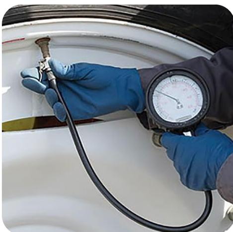
3. Комплектные колеса для тракторов, комбайнов и другой самоходной сельскохозяйственной техники используемые, как сдвоенные или дополнительные – бездисковые колеса, состоящие из обода и проставки, отгружаются клиенту или на склад филиала с давлением в шинах на 0,7 bar меньше указанного на бортовой поверхности шины.
